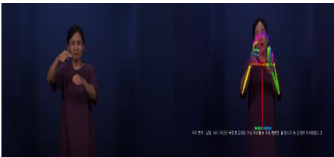
<그림 2> Open Pose 를 사용하여 수어 인식
