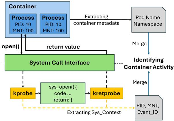
(그림 1) 실시간 컨테이너 모니터링 시스템
