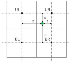
(그림 5) Bilinear Interpolation<sup>[3]</sup>
