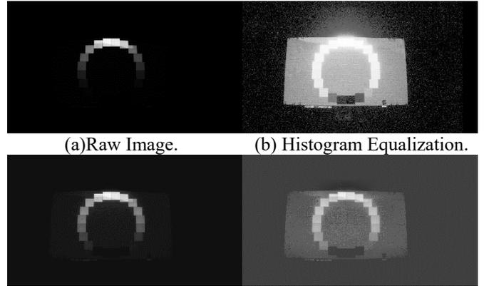
(a) Raw Image. (b) Histogram Equalization. (c) CLAHE(상한값:8). (d) CLAHE(상한값:32). (그림 6) 실험 원본과 각 알고리즘 별 적용 결과
