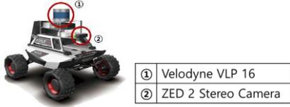
(그림 1) 자율주행 로봇의 센서 구성
