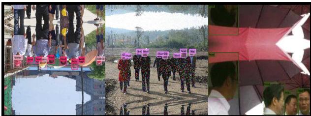
<그림 1> 순서대로 180° 회전 적용, Gaussian Noise 적용, 객체를 기준으로 한 Cropping 적용
