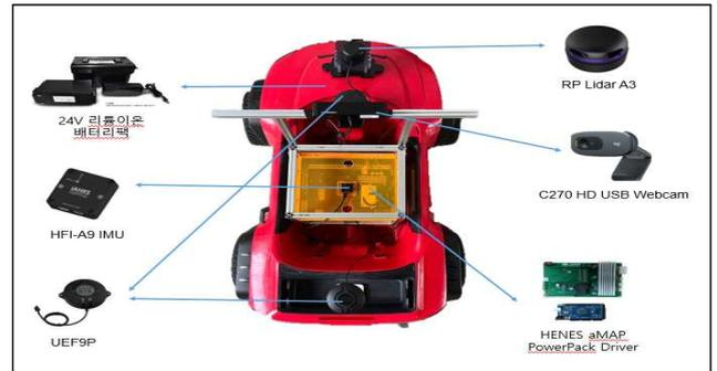
[그림 1] 1/5 scale 차량 H/W 구성도
