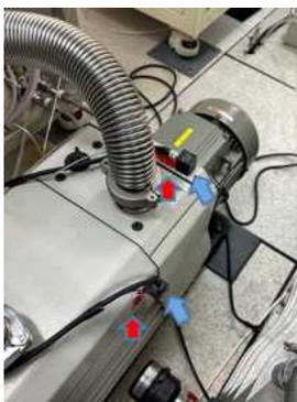
그림 1. 진동 센서 및 온도센서의 부착
