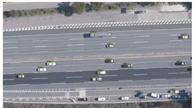
(그림 2) 직접 학습한 YOLOv7 모델을 가지고 차량 탐지(detection)한 모습. 탐지된 Namsa 비디오 중 한 장면을 캡처.
