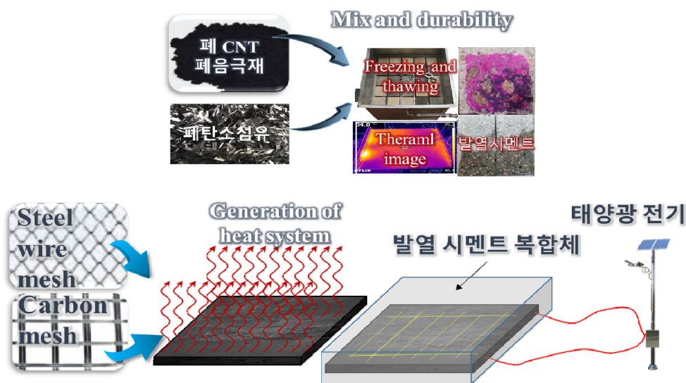
그림 1. 폐 탄소 소재를 혼합한 시멘트 복합체의 발열 시스템 개념
