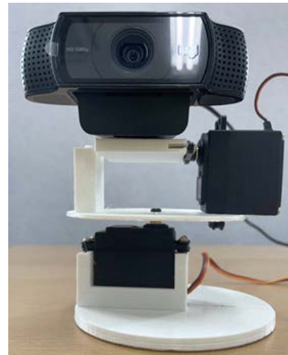
그림 3. pan-tilt 제어 구조물 완성 예시
