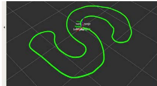
(그림 5) robot odometry 실험 결과(눈금단위 5m)
