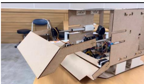
(사진 12) 리니어 모터와 로봇 arm 과 door 의 작동 성능 확인
