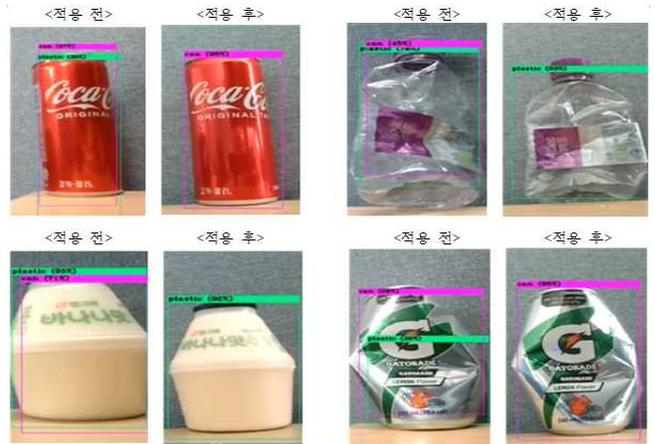
(그림 2) K-means clustering 적용 전, 후 비교결과
