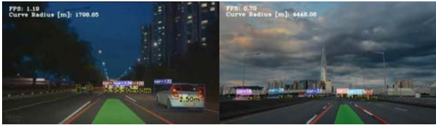
(그림5) 개발 System 1 (그림6) 개발 System 2 그림7, 8은 후미등 검출에 대한 개발이 완료된 모습이다. 2.3절에서 설명한 방식을 이용하고 그림5와 같이 상황에 따라 후미등 Box의 색을 다르게 표현하여 사용자가 더 직관적으로 현재 상태를 파악할 수 있도록 도와준다.
