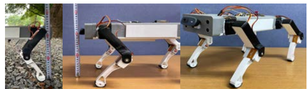
(그림 5) 로봇의 높이 21cm / 카메라 각도 상향 15도
