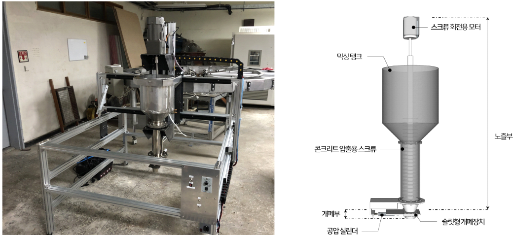
그림 1. FCP 제작용 3D 프린팅 콘크리트 노즐 및 구성요소
