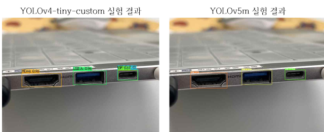
그림 7 YOLOv4-tiny-custom과 YOLOv5m 알고리즘을 이용한 실험 결과 비교
