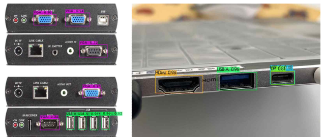
그림 4 YOLOv4를 활용한 객체 탐지 결과
