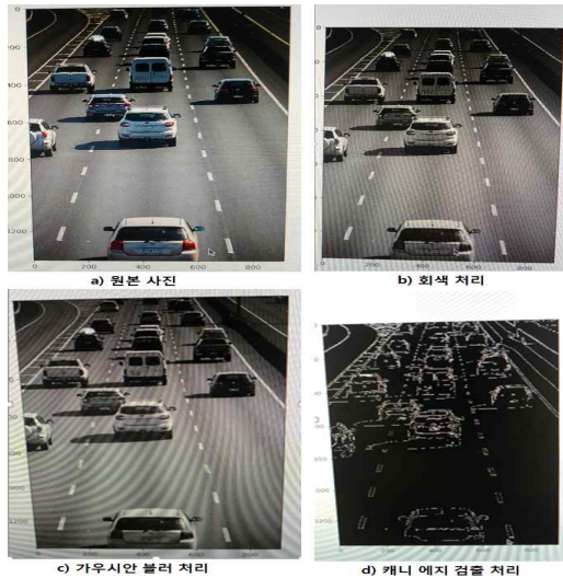
그림 4. 문턱 값을 이용한 에지 처리
