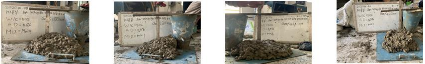
그림 2. 콘크리트 슬럼프 시험 결과
