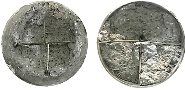
(a) 급속가열 (b) 저속가열 그림 1. 고강도 콘크리트의 폭발성상
