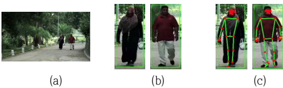
그림 2. (a) 원본 영상 (b) YOLOv4 모델 객체 검출 결과 (c) Mediapipe 자세 추정 결과
