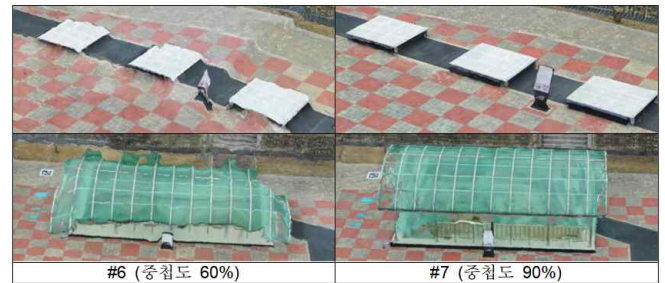
Fig. 5. 중첩도에 따른 3D 모델 품질 차이
