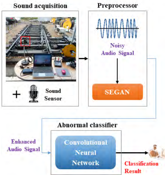
(그림 1) 선로 전환기 이상 상황 식별 시스템 구조
