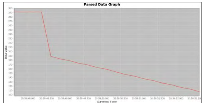
그림 5. 라이다 센서 로그로부터 얻은 거리 데이터
