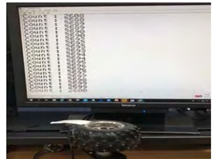
(그림 5)encoder mode를 이용한 Hall sensor count
