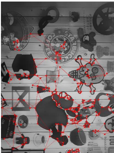
그림 2. 삼각형 정합쌍을 생성한 영상의 예시
