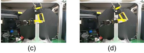
그림 3 4축 여유자유도 암의 연속동작 실험 모습
