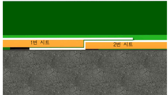
그림 2. 시트 간 겹침부 탑다운 구조 개념도
