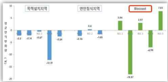
◆ Biocoast 시공 설치 지점도 해수욕장 입구 돌출부도 인한 심각한 침식 피해 지점임에도 불구하고 Biocoast 설치 후 퇴적 발생 (유속 설명 참조)
