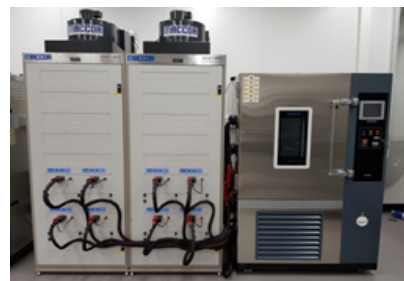
그림 2 배터리 충방전기(MACCOR) Figure 2 Battery Charger / Discharger (MACCOR)
