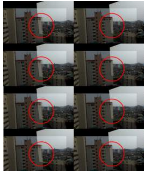
[그림 5] 선형 호모그래피 행렬을 사용하여 스티칭(좌), 센서 데이터로 이미지 전처리를 수행한 후 스티칭(우)
