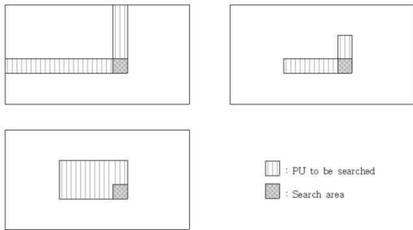
그림 1. (a) 전체 1D 수평·수직 탐색 방법 (b) 제한된 영역 내 1D 수평·수직 탐색 방법 (c) 제한된 영역 2D 탐색
