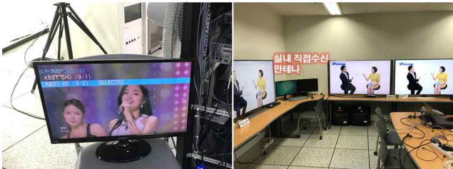
[그림 3] (좌) STLTP 모니터링 시스템(마루이엔지) 영상 확인 (우) 상용 ATSC3.0 UHDTV 온에어 직접수신 영상 확인
