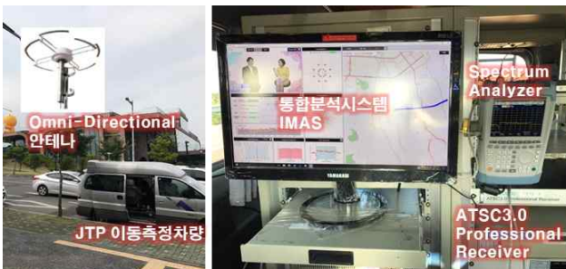
[그림 4] (좌) 이동측정차량 외관 및 이동측정용 안테나 상세 모습 (우) ETRI 수신시스템 구성도: ATSC3.0 Professional Receiver(클레버로직), 통합분석시스템 IMAS(에니퓨처릭) 등
