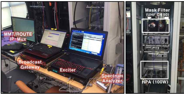
[그림 2] ETRI 송신시스템 구성도: IP-MUX(카이미디어), Broadcast Gateway(마루이엔지), Exciter(클레버로직), 스펙트럼분석기 등
