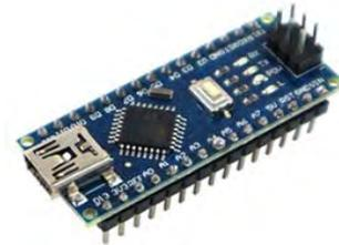
(그림 3) Arduino Nano
