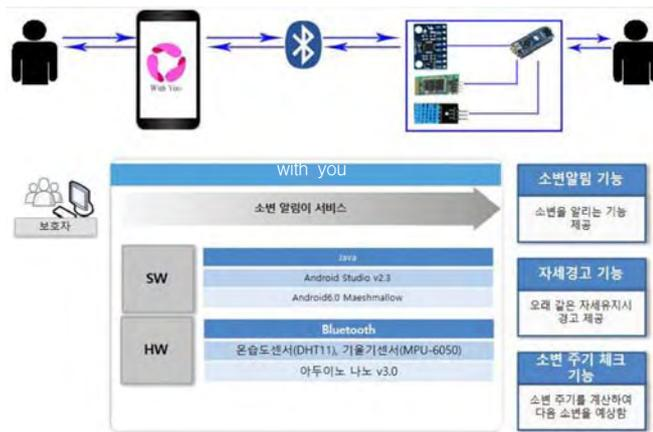
(그림 1) 전체 시스템 구조
