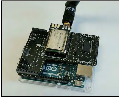
(그림 5) 실험에 사용된 노드: Libelium 사의 LoRaWAN 900 모듈과 4.5 dBi 안테나를 사용한다.
