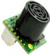
그림1. 본 연구에 사용된 초음파 센서(XL-MaxSonar-EZ0)
