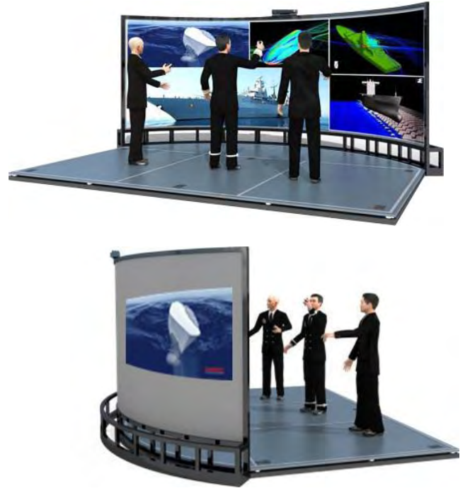
(그림 3) 모션기반 휴먼 인터페이스를 이용한 가상환경 조작용의 개념도
