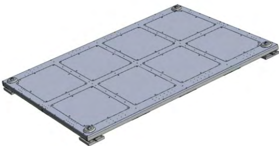
(그림 2) 다중 포스-센서 내장형 모션 플레이트의 설계도
