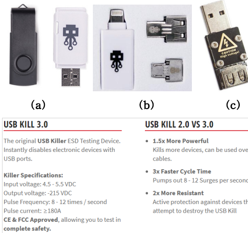
그림 1. USB 킬러 (a) 외형, (b) 어댑터, (c) 테스터, (d) 주요스펙
