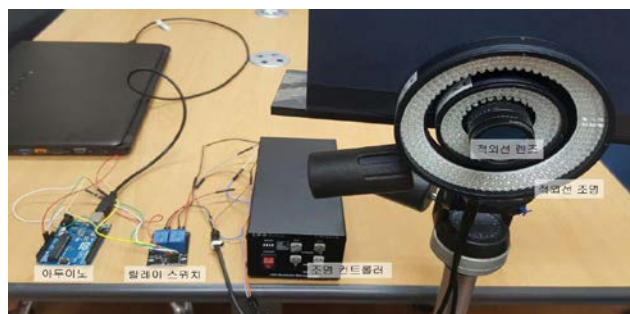
그림 1. 눈 검출 하드웨어 시스템
