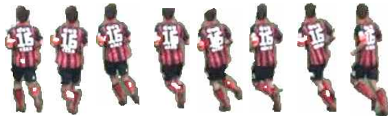
그림 7. 연속 프레임 영상에서 Grab-Cut 알고리즘 적용에 의한 객체 영역 분할 결과
