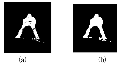
그림 4. 커널 기반 트래킹 결과 획득한 백프로젝션 영상(a)과 모폴로지 연산 수행 후의 영상(b)
