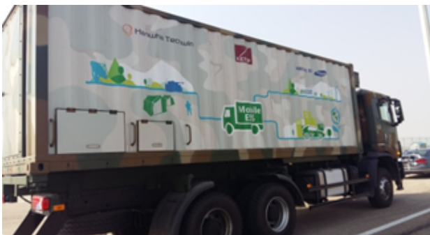
그림 1 이동형 ESS Fig. 1 Mobile ESS
