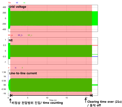
그림 3 정격전압의 70%( 60%<V<88% ) grid 전압으로 21s이상 지속 시의 시뮬레이션 결과 파형
