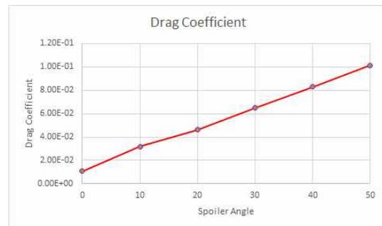
Fig. 4 Drag coefficient
