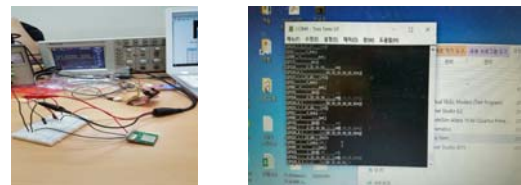
그림 3. 사용 모듈 파형 테스트, GPS 모듈에서 ATmega128로 UART를 통해 전달 값 확인
