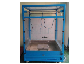
Fig. 2. The Sprinkling System.
