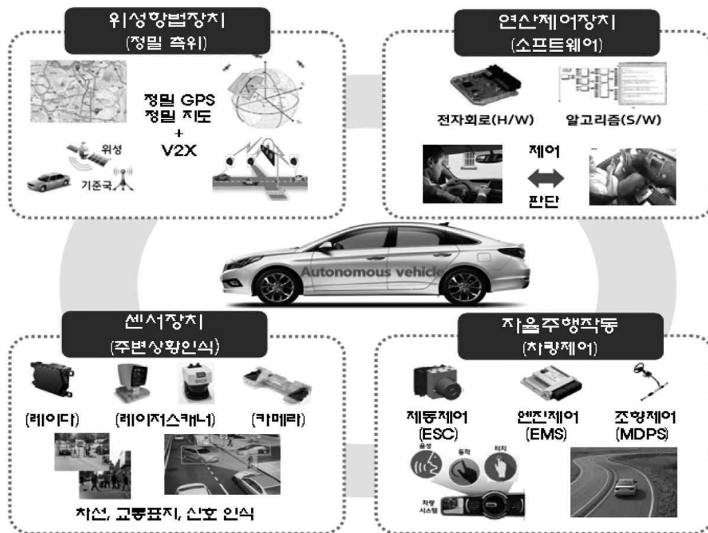
[그림3] 자율주행 자동차 시스템 구성도 16)
