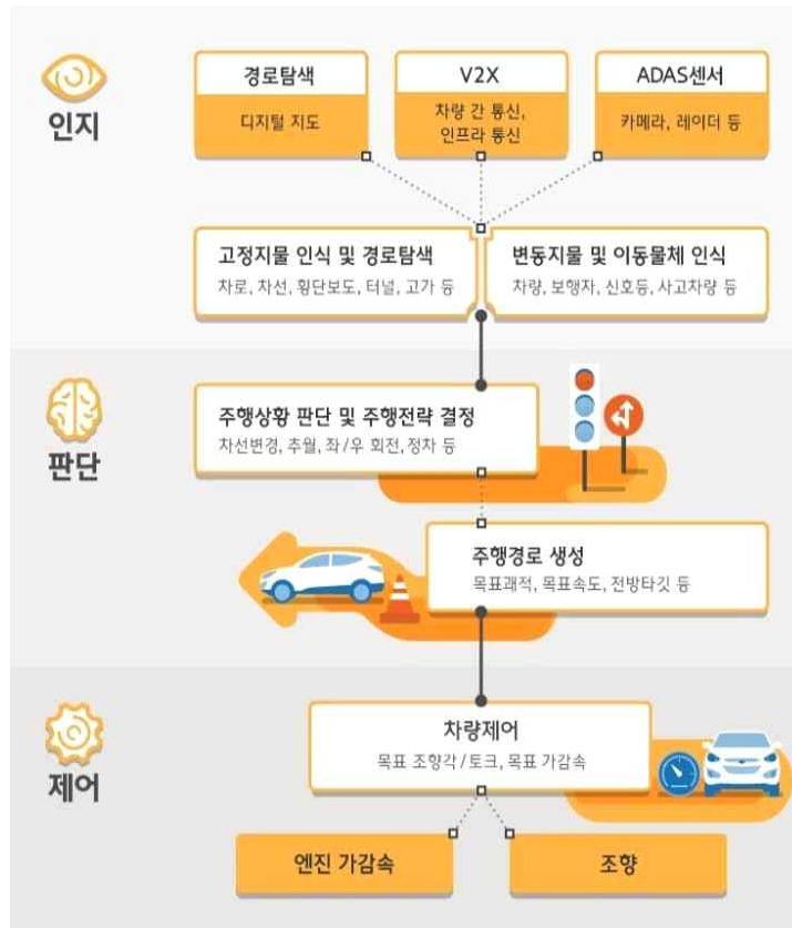
[그림2] 자율주행 자동차 시스템 프로세스
