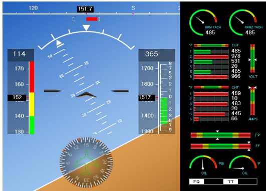
Fig 2. 개발 MFD EFIS/EMS 모드
