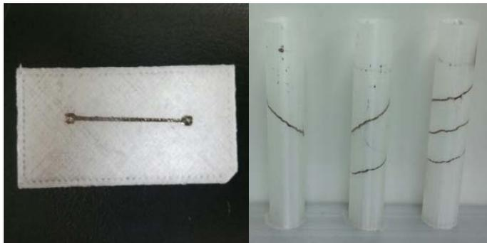
Fig. 1. (좌) Flat TPU와 (우) cylinder 표면에 프린팅 된 silver 회로 형상
