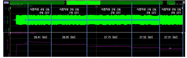
〈그림 7〉 진상부하 차량 투입에 따른 전압변동 측정
