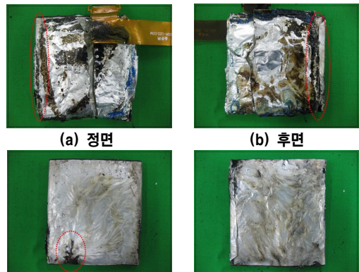
(a) 정면 (b) 후면 (c) 정면(film case 제거후) (d) 후면(film case 제거후) <그림 2> 사고 Li-Polymer 배터리 외형
