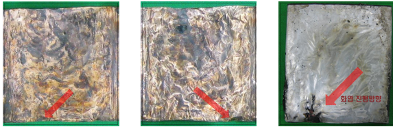
(a) 내측(A-3) (b) 외측(A-3) (c) 정면(커버방향) 〈그림 5〉 배터리 음극 탄화패턴에 따른 화염 진행 방향 분석
